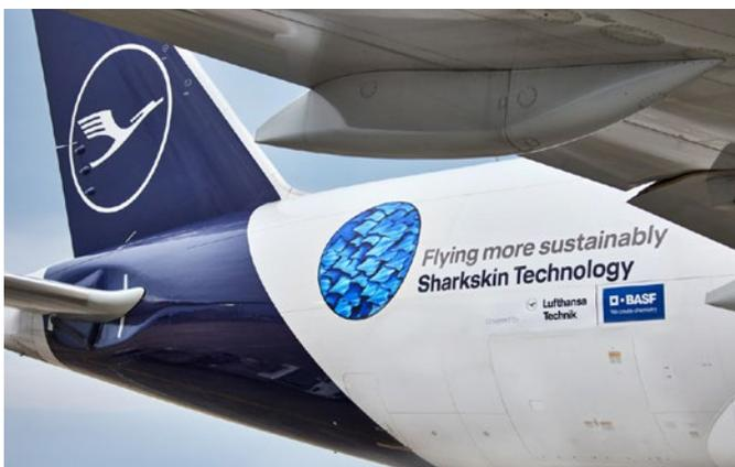
Die Oberflächenstruktur „AeroSHARK“, die der feinen Struktur von Haifischhaut nachempfunden ist, soll ab Anfang 2022 auf der gesamten Frachterflotte der Lufthansa Cargo zum Einsatz kommen. Sie optimiert die Aerodynamik an strömungsrelevanten Stellen des Flugzeuges. Lufthansa Technik rechnet mit einer Reibungsminderung von mehr als einem Prozent.
